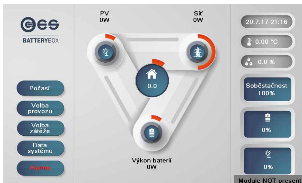
Obr. 17 – základní obrazovka na LCD displeji systému CES BATTERY BOX
